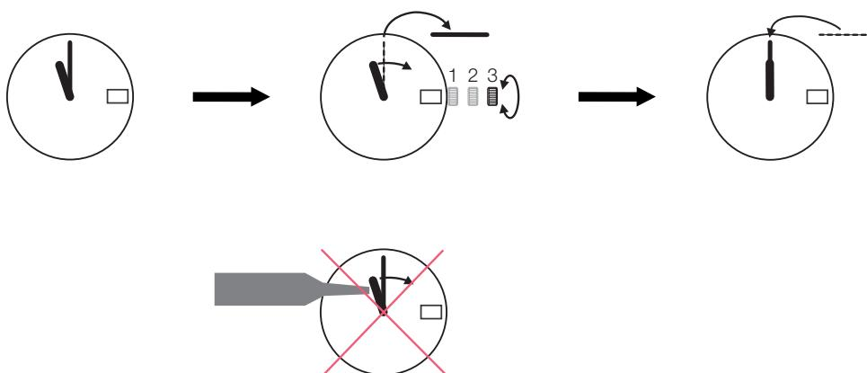
Pour la pose des aiguilles, utiliser impérativement un porte-pièce avec des appuis et des dégagements appropriés.
